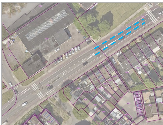
Figuur 9 Door gemeente aangereikte foto; het weggedeelte met blauwe stippellijn heeft SMA-NL8
